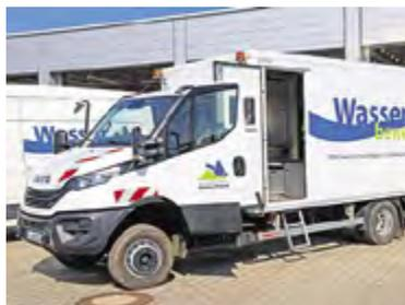
Technik bis unters Dach: Im Rückraum ist das Kamerasystem untergebracht. Mit dieser ausgefeilten Technik können Abwasserrohre von 150-2000 Millimeter Durchmesser gefilmt werden. Foto: ZVME/Kahle
