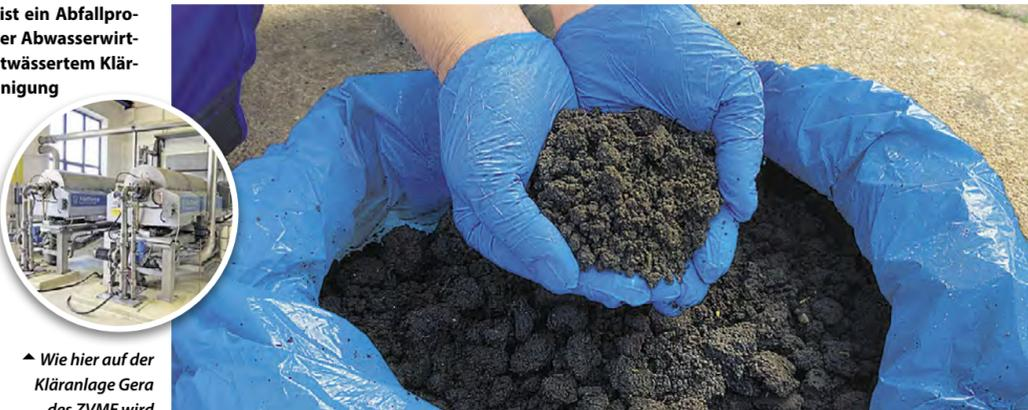
Wie hier auf der Kläranlage Gera des ZVME wird Klärschlamm mithilfe von Zentrifugen entwässert.
